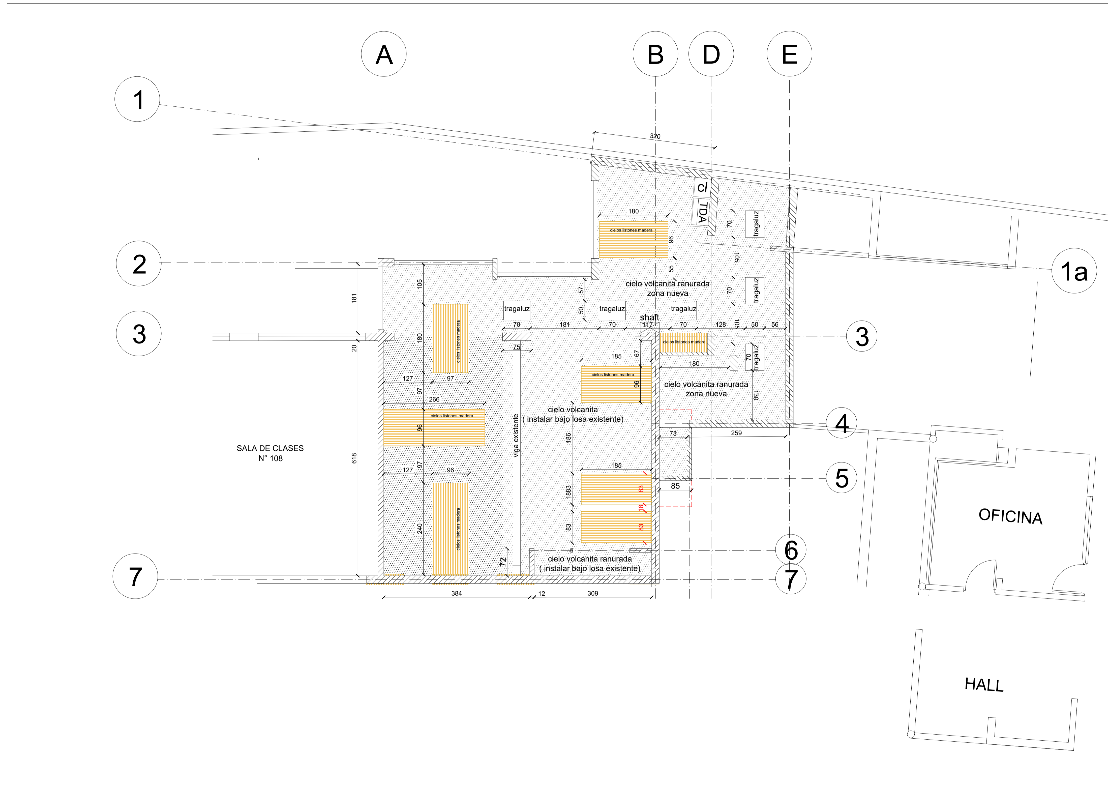
PLANTA CIELOS AMPLIACIÓN BIBLIOTECA / ESCALA 1:50
